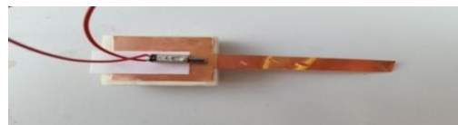
Fig.4 Prototip cu deplasare cu motor prin vibrații(lateral)
